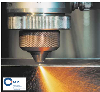
Découpage au laser d'une plaque d'acier d'1mm d'épaisseur à la vitesse de 40m/min avec régulation de distance.
