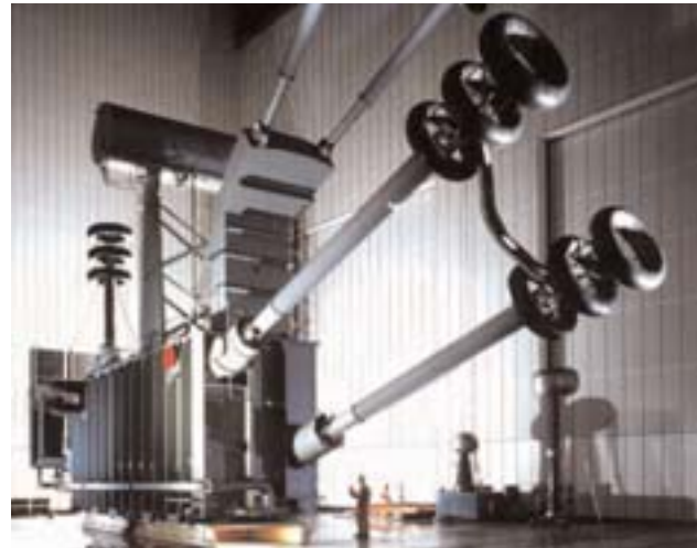
Abb. 1: Hochspannungstransformator mit Durchführungen (Foto: HSP - Köln Porz)
