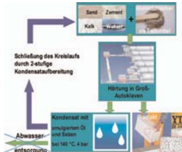
Abb. 1: Reinigung des Kondensats innerhalb eines geschlossenen Kreislaufes (Grafik: Solar-Institut Jülich)
