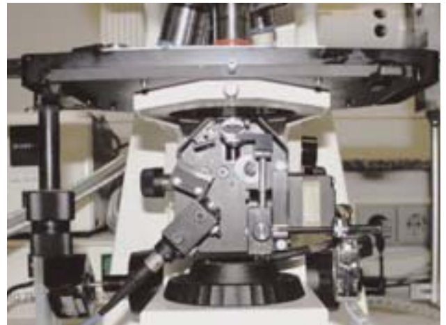
Die Beleuchtungseinheit für TIRFM besteht aus einem an der Hochschule Aalen entwickelten Mikroskop-Kondensor, bei dem Licht über eine Glasfaser, einen einstellbaren Spiegel und eine Glashalbkugel unter Totalreflexion bei variablem Winkel auf die Probe eingekoppelt wird. Der Kondensor erlaubt zusätzlich eine konventionelle Auflicht- und Durchlichtbeleuchtung (einschließlich Phasenkontrast). (Foto: HS Aalen)
