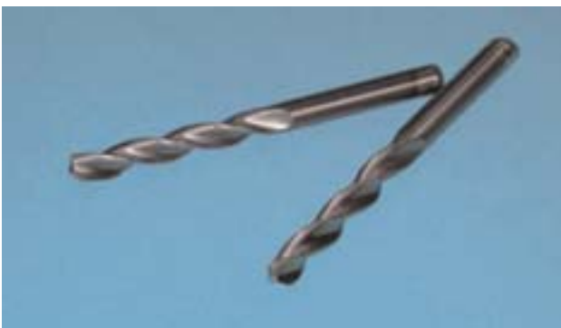
Abb. 2: Hartmetallbohrer als Anwendungsbeispiel für eine DLC-Schicht auf Metall (Foto: Hochschule Mittweida)
