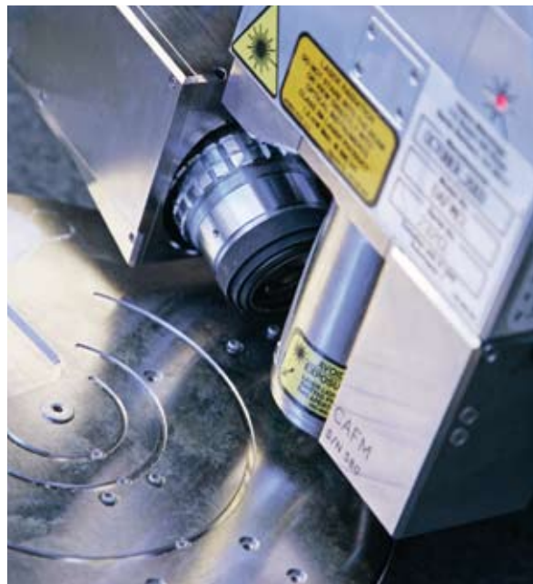
Teilansicht: Die Auflösung der Mikroskopoptik beträgt 1,5 Mikrometer.
