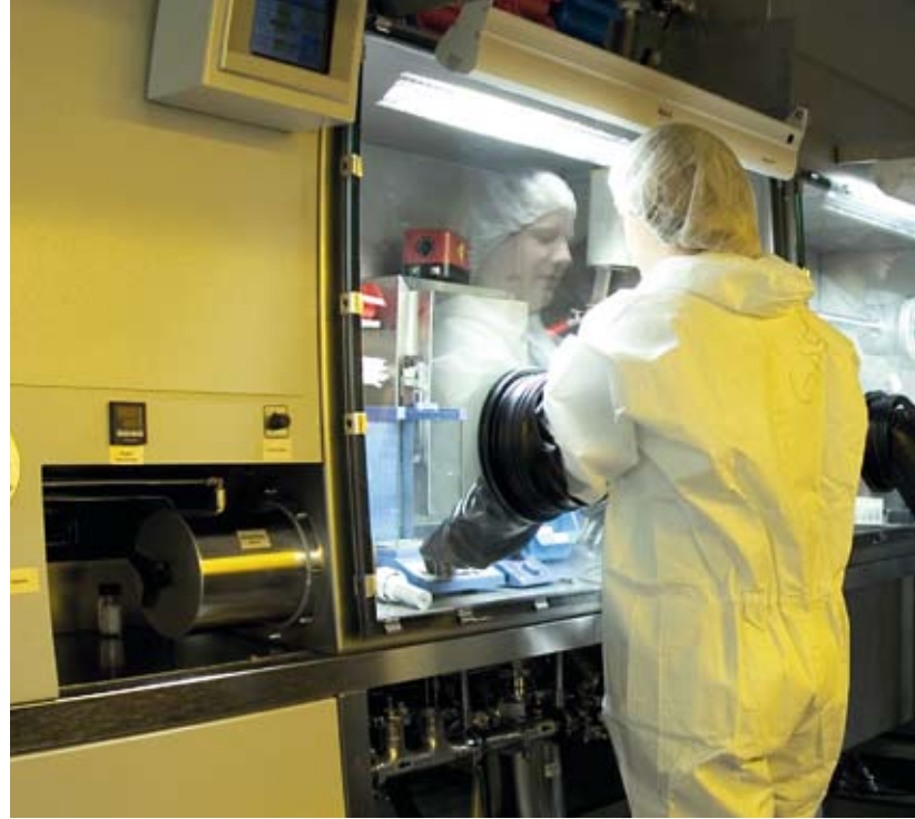
Im Handschuhkasten werden organische Bauelemente hergestellt.
