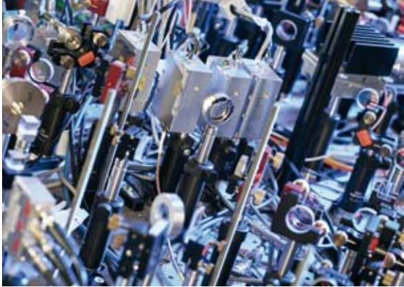
Im Versuchsaufbau leiten Linsen das Laserlicht zum Atom. Über ...
