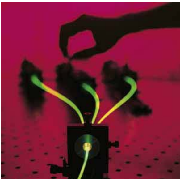
Ytterbium-dotierter Faserverstärker, Quelle: Fraunhofer IOF
