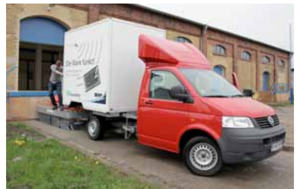
Die Ware funkt – Abrollen eines Wechselbehälters an der Halle des Galileo-Testfelds Sachsen-Anhalt (Quelle: Dirk Mahler/Fraunhofer IFF)
