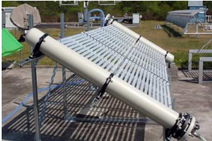
Abb. 2: Sauberes Wasser durch Licht: Photokatalytische Verfahren können zur Reinigung von Industrieabwässern z. B. in der Textilindustrie eingesetzt werden
