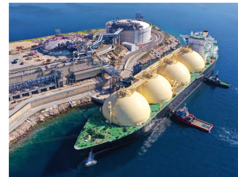
Flüssiggas wird mit Spezialtankern transportiert.
