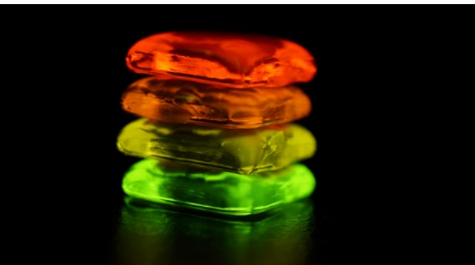
Mit Leuchtstoffen versetzte Gläser unter Einwirkung von ultravioletter/blauem LED-Licht
