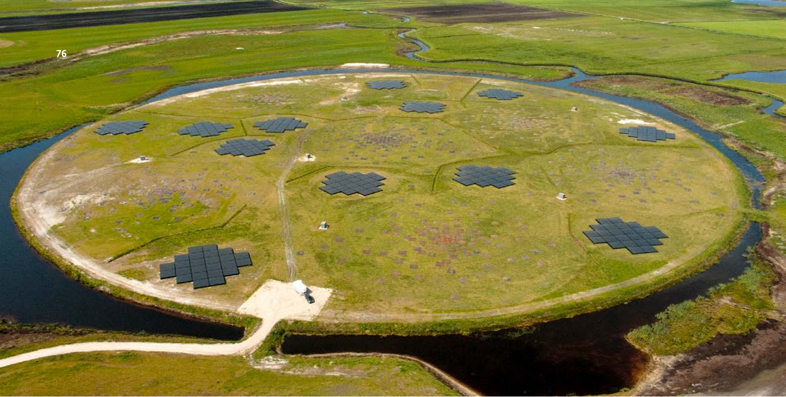
Projektbeispiel aus dem EFR: LOFAR, Low Frequency Array, ein Weltraum-Radioteleskop aus miteinander vernetzten Antennenfeldern von Irland bis Polen. Besonders viele Stationen stehen in Deutschland und in den Niederlanden wie hier nahe Exloo.
