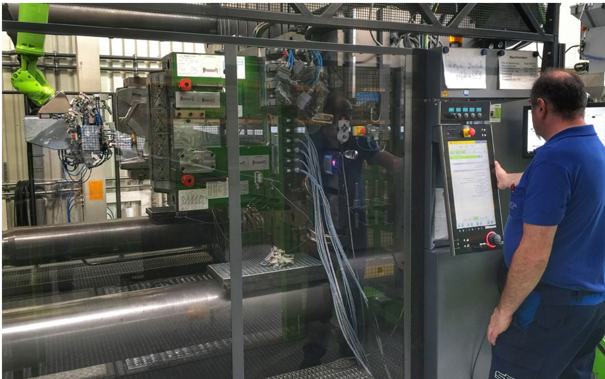
Die Produktion von Stoßfängerüberzügen erfolgt hier auf einer 4.000-Tonnen-Spritzgießmaschine.
