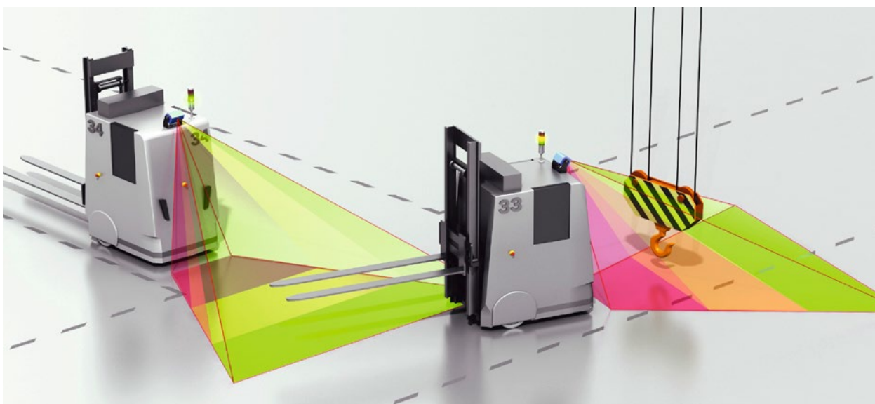
On-Board-Sensoren sichern die Umgebung ab.
