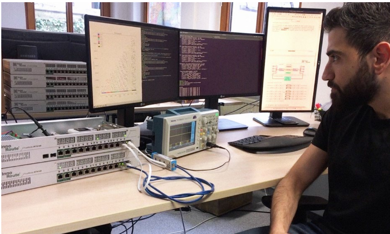
Die Modularität der im Projekt entwickelten Routerplattform erlaubt eine flexible Integration neuer Netzwerktechnologien.
