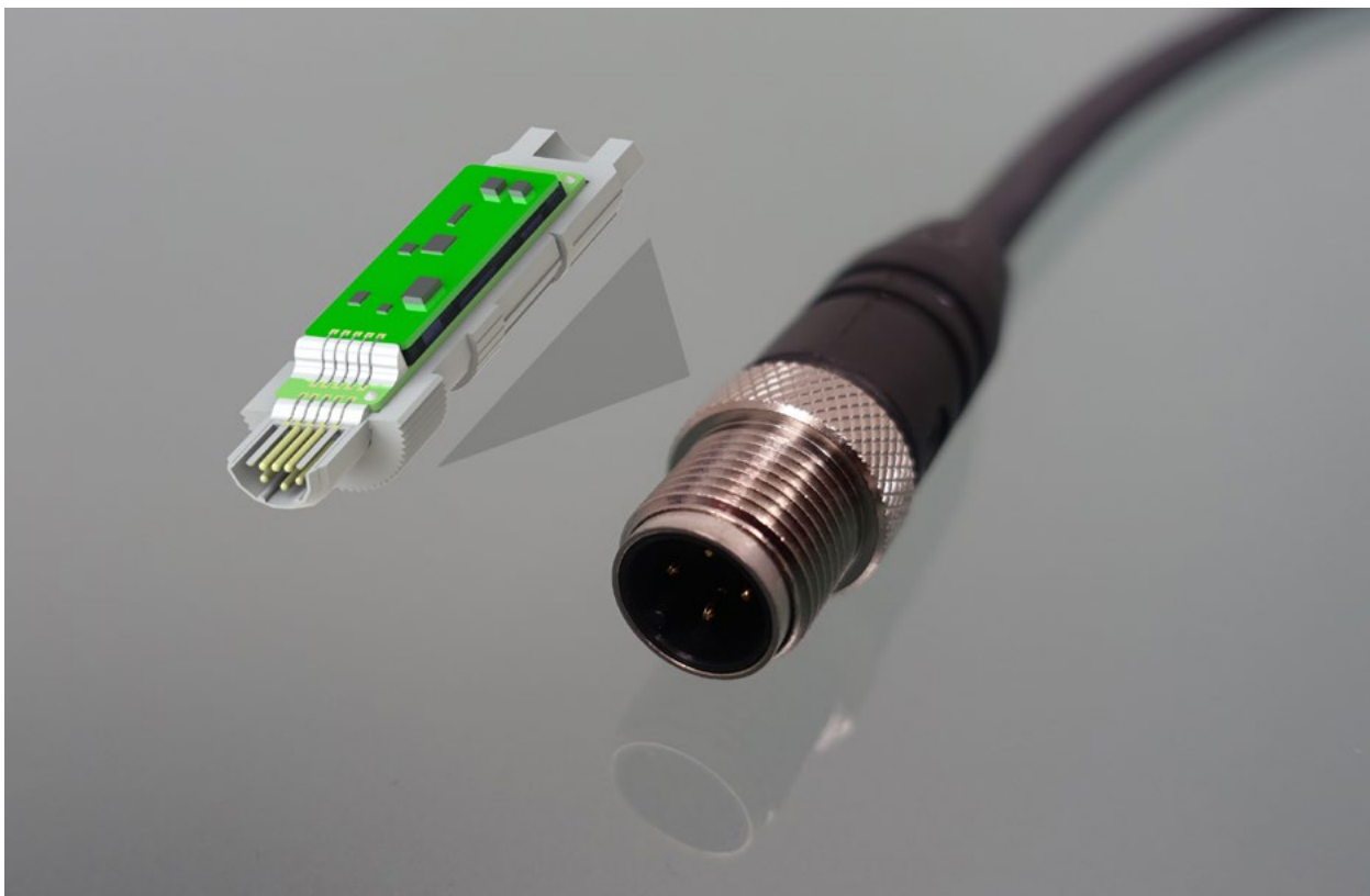
Der Fotoausschnitt zeigt einen intelligenten Steckverbinder mit integrierter Busanbindung für analoge Sensorsignale.
