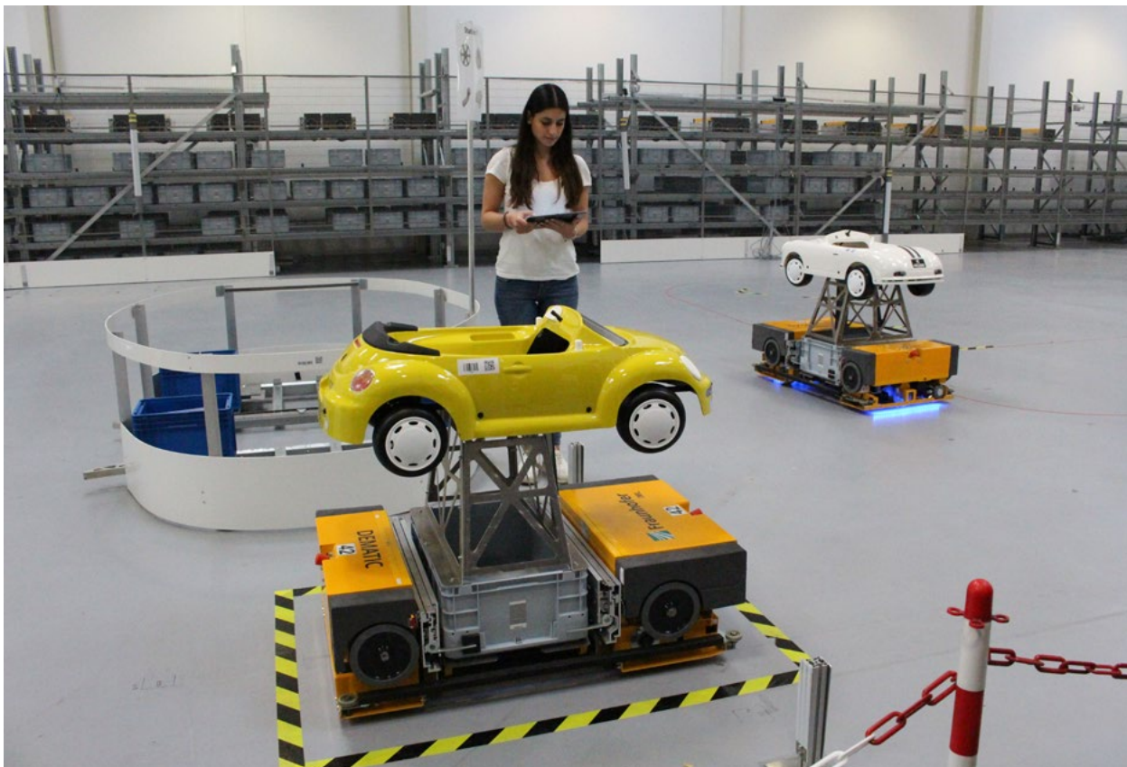
In einer Versuchseinrichtung werden zellulare Transportfahrzeuge erprobt.
