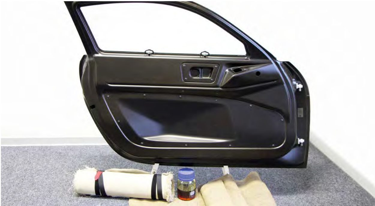
Aus biogenen Fasern, Harzen und Lacken entstehen am Fraunhofer-Institut für Holzforschung Leichtbauteile für das Bioconcept-Car.
