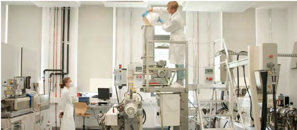
In der Extruder-Anlage am Fraunhofer-Institut für Verfahrenstechnik und Verpackung in Freising werden Lupinensamen verarbeitet.
