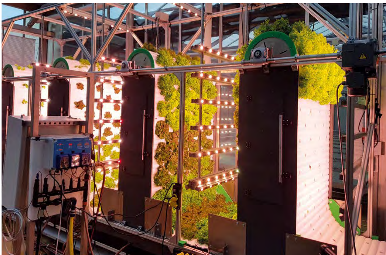
Salat vom Fließband: Das automatisierte, vertikale Pflanzenaufzuchtssystem OrbiPlant am Fraunhofer IME in Aachen
