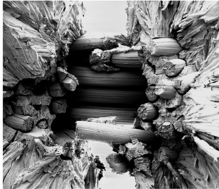
Elektronenmikroskopische Aufnahme der Bruchstelle eines Wolfram-Faserverbundwerkstoffs. Dessen Verwendung im Fusionsreaktor könnte bei den vorherrschenden Temperaturen helfen, thermische Spannungen besser abzufangen und Rissbildung zu begrenzen
