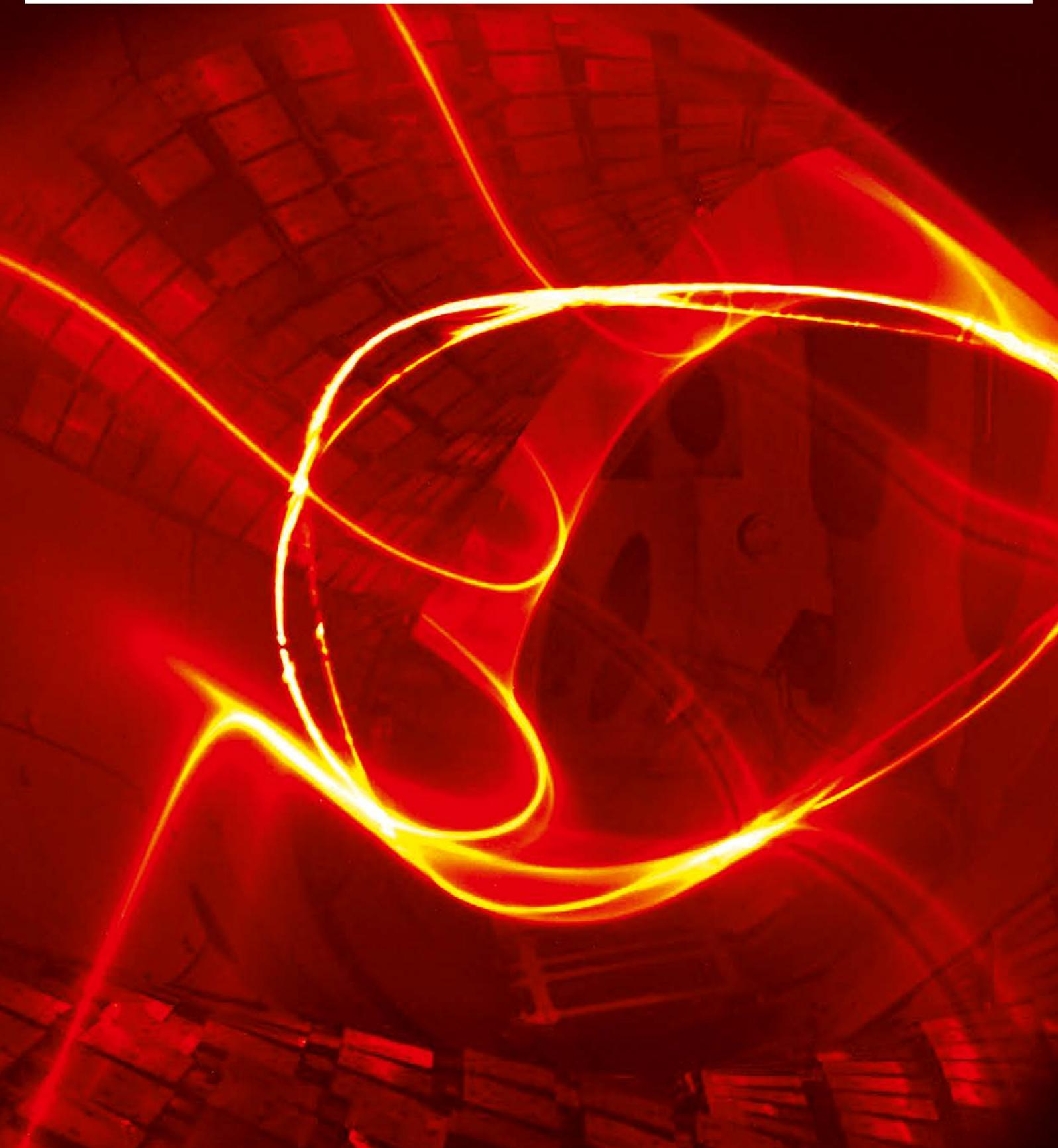
Titelbild: Blick in das Plasmagefäß der Fusionsanlage Wendelstein 7-X. Zur Visualisierung eines Teils des komplexen Magnetfeldes wurde ein Elektronenstrahl längs einer magnetischen Feldlinie in Umlauf gebracht. Auf seinem vielfachen Umlauf längs der Feldlinie erzeugt er eine Leuchtspur. Das Foto kombiniert diese Leuchtspur mit den Bildpunkten, die der Elektronenstrahl auf einem fluoreszierenden Stab hinterlässt, der durch die Bildebene geschwenkt wird.
