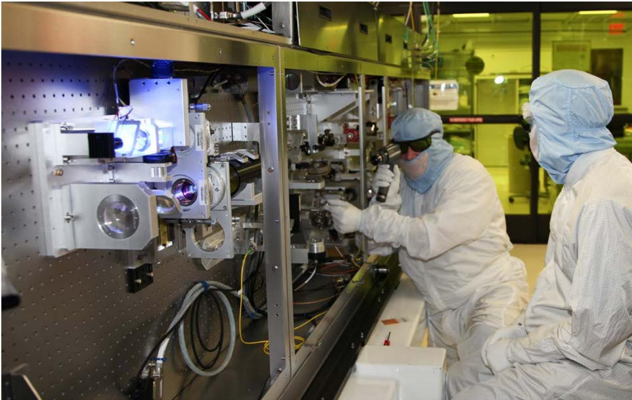
Für die Laserfusion müssen die erforderlichen Laser mit großer Präzision justiert werden
