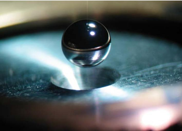
Die NIF-Brennstoffkapseln sind ca. 2 mm große polierte Hohlkugeln aus Kunststoff, Diamant oder Beryllium, die mit gefrorenem Wasserstoff gefüllt werden
