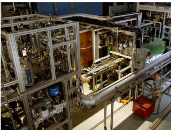
An der MEKKA-Einrichtung (Magnetohydrodynamic Experiments in NaK Karlsruhe) des KIT können Flüssigmetall-Strömungen für Fusionsanwendungen untersucht werden
