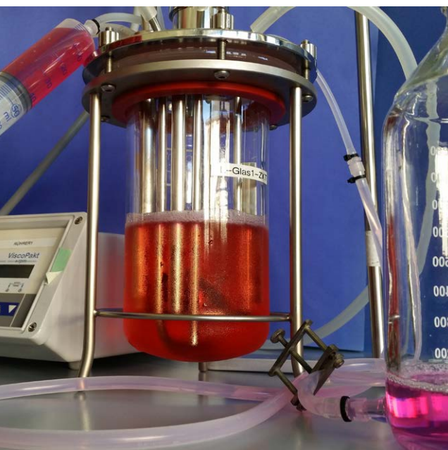
Bioreaktor für die effektive und sichere Herstellung von Masern-Viren gegen Krebs.
