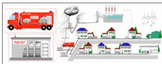
SES 2 -Modell der Minimalversorgung im Krisenfall durch regenerative und dezentrale Stromquellen (Quelle: Egon Ortjohann)
