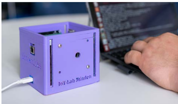
Messung von Raumluftparametern mit SensorCube.
