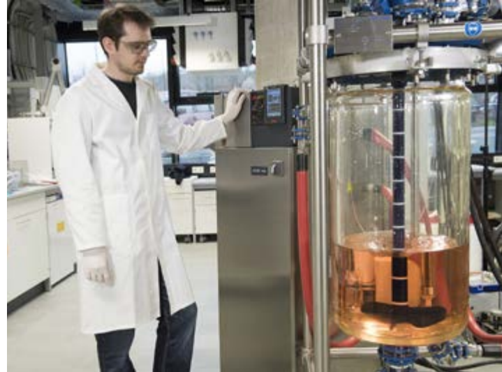
Der Rührreaktor für Partikelsynthesen im Maßstab 100 Liter
