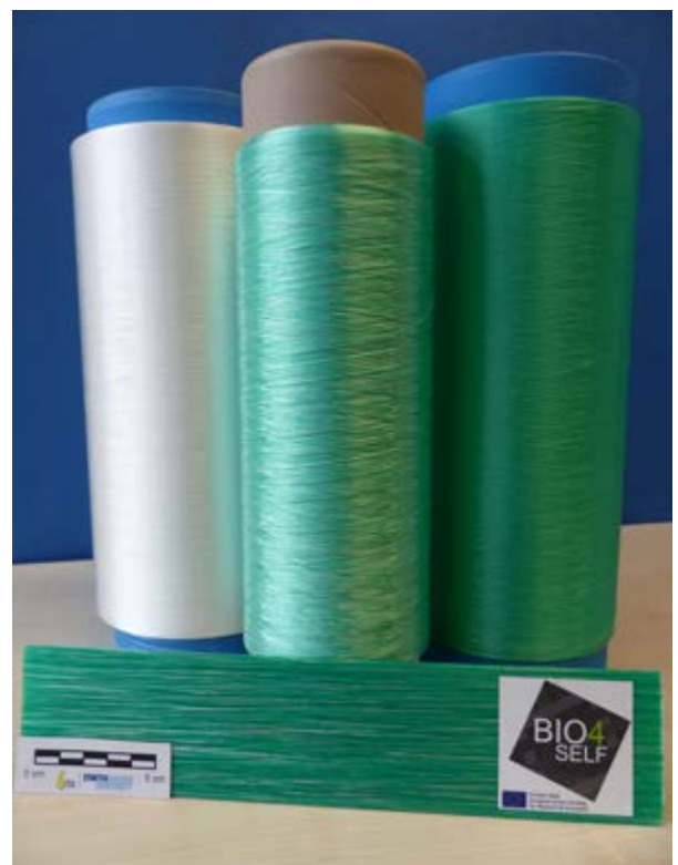
Eigenverstärkter Faserverbundkunststoff (eFVK) aus PLA und PLA-Fasern
